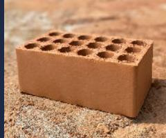
Ladrillo producido de arcilla moldeada y extruida, sometido a cocción en un horno túnel de operación continua.
