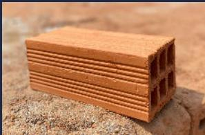
Ladrillo producido de arcilla moldeada y extruida, sometido a cocción en un horno túnel de operación continua.
